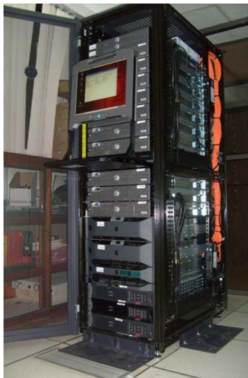
Equipo de cómputo de alto rendimiento tipo clúster, con veinte procesadores Xeon de núcleo cuádruple.
