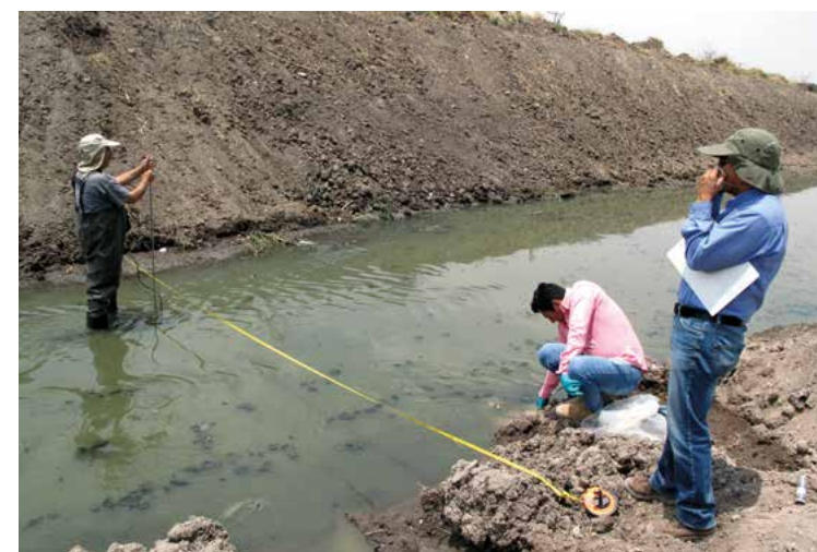
Mediciones de caudal en el río Querétaro para la modelación de calidad del agua
