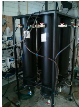
Instalación experimental biorreactores con lecho sintético para remoción de ácido mefenámico, fluoxetina y metoprolol.
