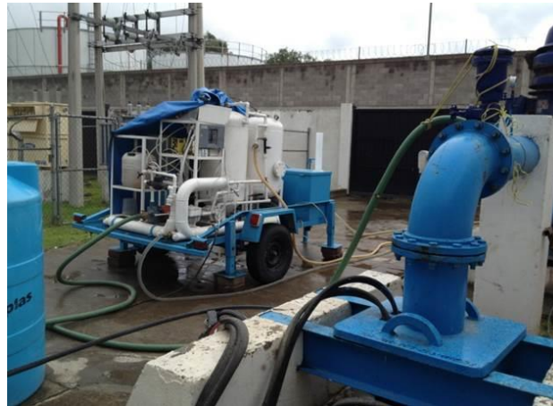
Planta piloto (filtración directa).
