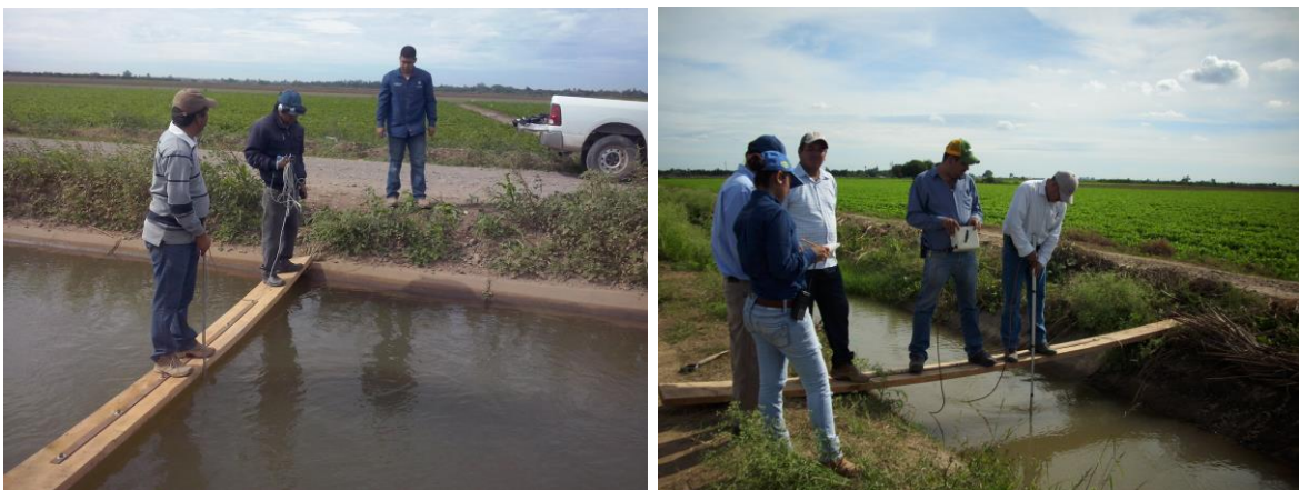
Aforo en puntos de control en módulo I-1 Bamoa.
