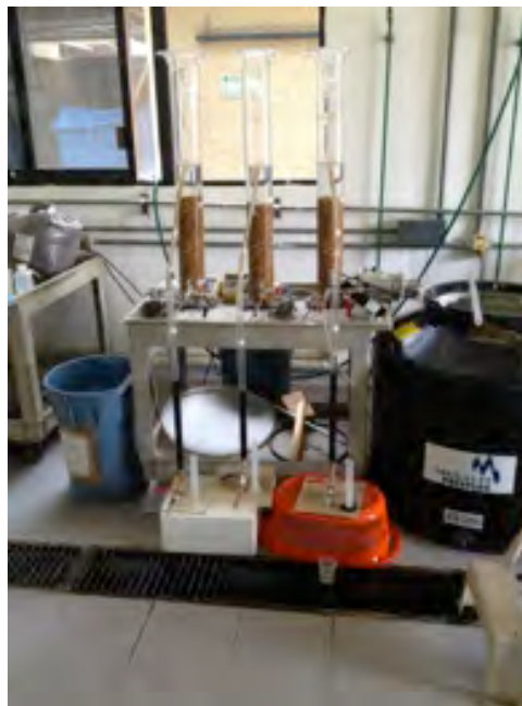
Pruebas de adsorción de fluoruros y arsénico con carbón de hueso.
