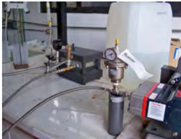
Circuito de membranas con amortiguador de pulsaciones.
