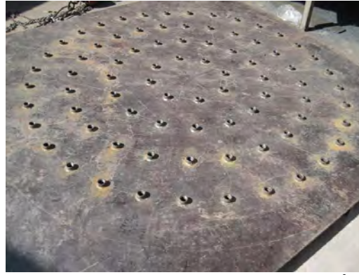
Soporte de toberas para el bajo dren de los filtros a presión.
