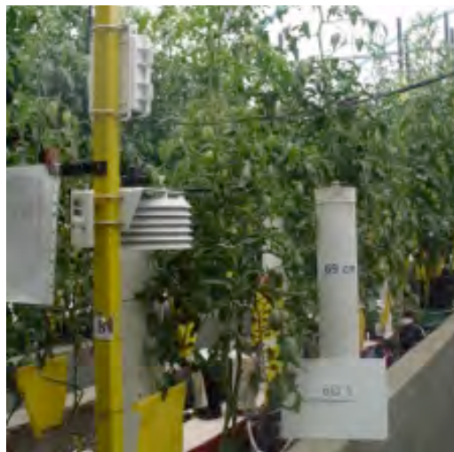
Medición de parámetros con estación agroclimática y de consumo de agua con microlisímetro de succión.
