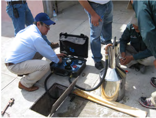
Prueba de errores de medición en sitio: probador portátil y medida volumétrica de veinte litros.
