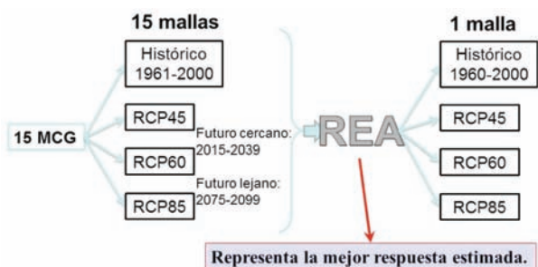
Diagrama de flujo para la regionalización estadística con el método REA de escenarios de cambio climático para la república mexicana.
