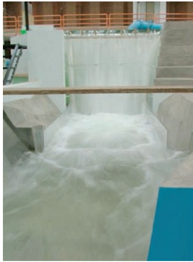
Comparación del escurrimiento del modelo de laboratorio y el simulado, así como la distribución de la densidad en la descarga de un vertedor escalonado.
