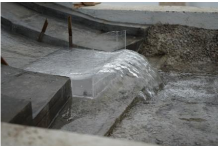
Propuesta final de modificación de la estructura terminal, ángulo 12^\circ , elevación labio 1 333.25 msnm (modelo hidráulico que simula el vertedor de la presa Tenango, en el laboratorio de Hidráulica).
