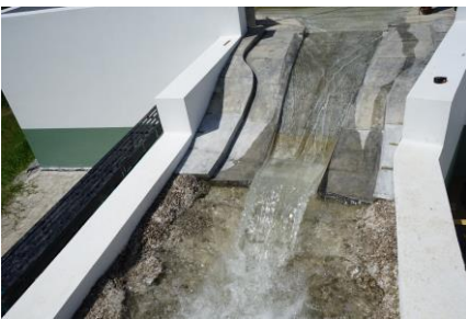
Comportamiento del flujo sobre el vertedor para Q = 535 \text{ m}^3/\text{s} (modelo hidráulico que simula el vertedor de la presa Tenango, en el laboratorio de Hidráulica).
