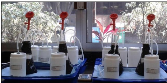
Arreglo experimental para evaluar la dinámica de sorción-difusión de BAP en S&S y CAG.
