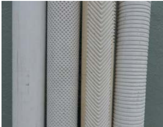
Rugosidades de pilas probadas (lisa, rugosa, rugosidad direccional y anillada).
