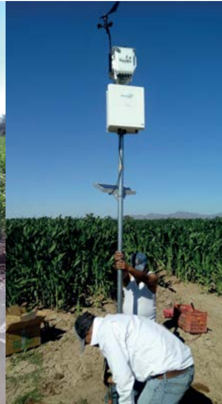
Instalación de estaciones meteorológicas con fines de pronóstico de riego en tiempo real.
