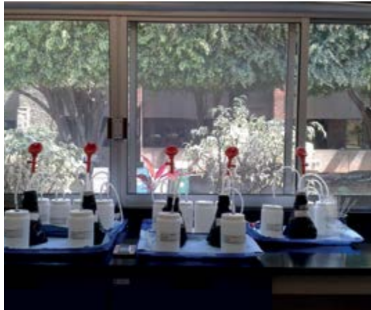
Configuración experimental para evaluar de dinámica de sorción-difusión-biodegradación de un HPA en S&S.
