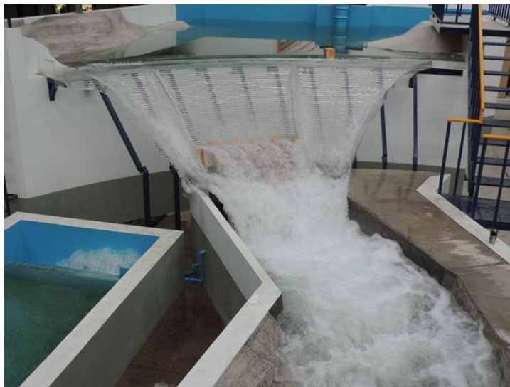
Funcionamiento del vertedor con modificaciones recomendadas
