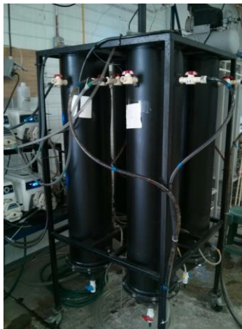
Instalación experimental de biorreactores con lecho sintético para remoción de ácido mefenámico, fluoxetina y metoprolol
