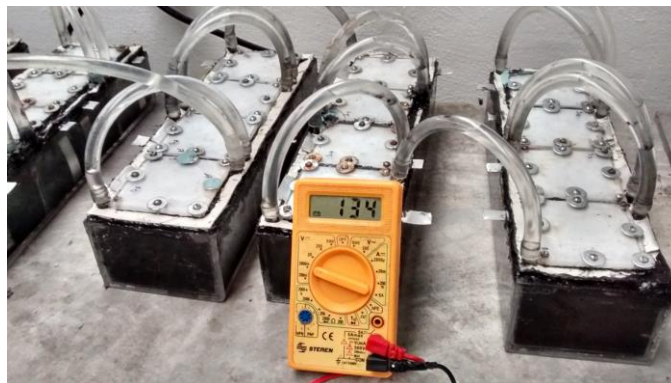
Sistema de multiceldas con veinte celdas de combustible microbianas
