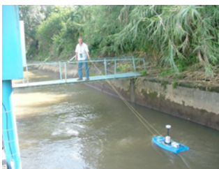
Proceso de verificación en el canal de comunicación de la presa Tuxpan-El Bosque km 0+130.
