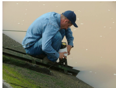
Limpieza de un medidor acústico de efecto Doppler lateral fijo.
