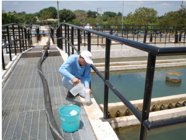
Pruebas de trazadores en el sedimentador de la planta potabilizadora Villa Parrilla, municipio de Centro, Tabasco.
