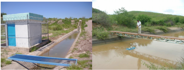
Estación de medición con un aforador de garganta larga (izquierda). Determinación del caudal con un equipo de perfilación acústica Doppler portátil (derecha).
