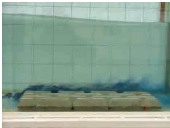
Flujo sobre el tapete 1 mediante un trazador colorante. Se aprecia el efecto del tapete sobre el flujo.
