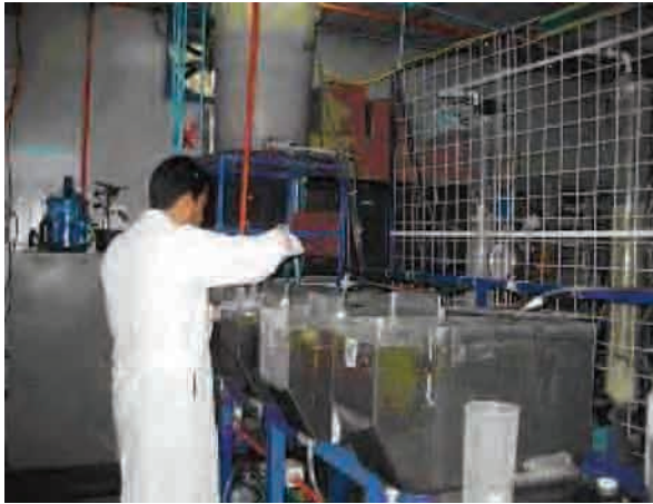
Pruebas de tratabilidad: Sedimentación primaria.
