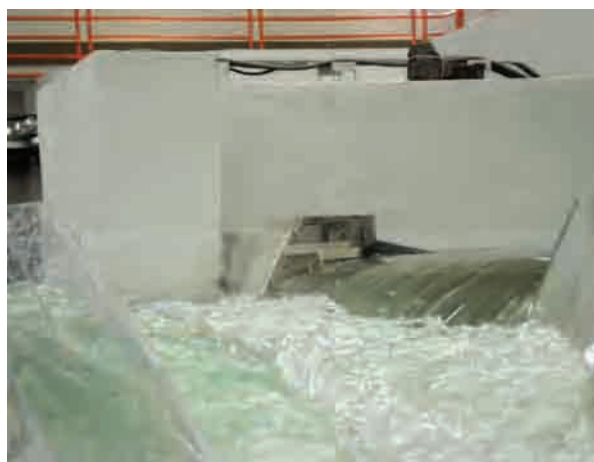
Modelo físico del vertedor de la presa El Hervidero, Colima. Funcionamiento para gasto máximo Q = 307 \text{ m}^3/\text{s} .
