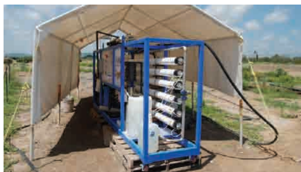
Equipo de ósmosis inversa del laboratorio del IMTA, utilizado en las pruebas de campo, Invernadero Santa Rita, San Luis Potosí.
