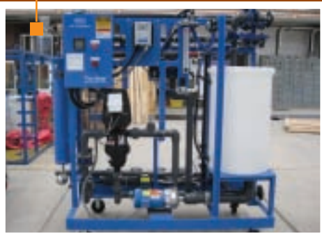
Equipo piloto móvil de microfiltración y ultrafiltración.
