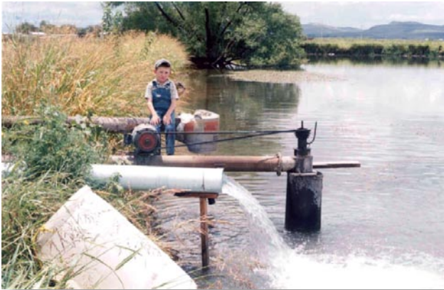
ALMACENAMIENTO DE AGUA DE BOMBEO EN UN ESTANQUE PARA RIEGO, NUEVO CASAS GRANDES, CHIHUAHUA
